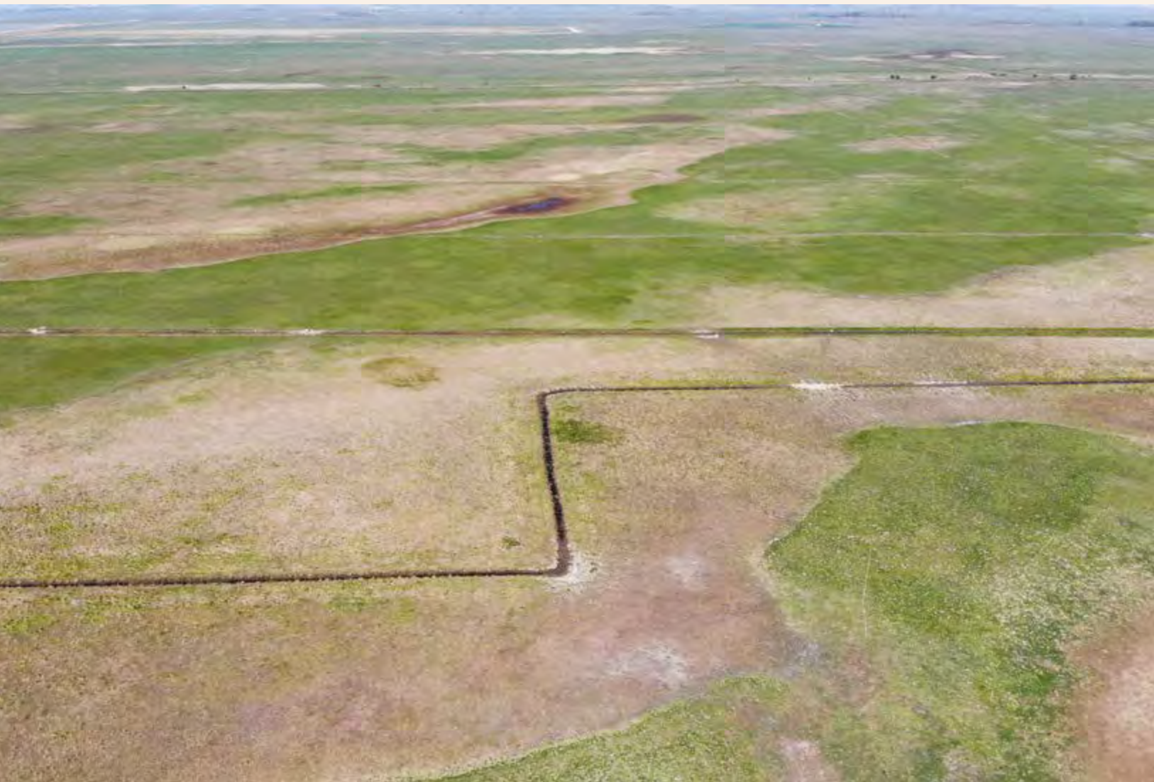
16. fénykép. Vízfénéken átvezetett, még fel nem számolt csatorna (BALLA DÁNIEL). Photo 16. Drainage system to be eliminated
