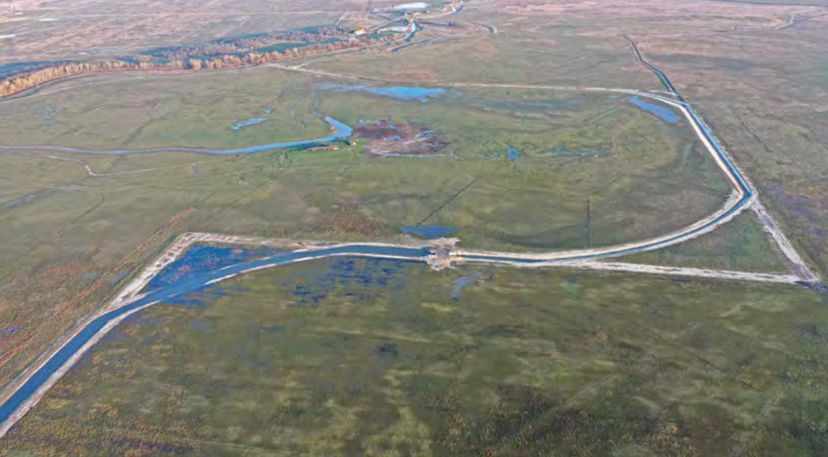
50. fénykép. A széles völgyezetté átalakított pentezugi Fekete-rétet keresztülszelő Kun Györgyi-halastó lecsapoló csatornája (LIFENAT14/HU/00938), amelynek szögletes törései íves kanyarulatokká lettek átváltoztatva (SZILÁGYI ATTILA). Photo 50. The drainage channel of the Kun Györgyi fishpond traversing Fekete-rét in Pente-zug, transformed into a wide valley (LIFENAT14/HU/00938). The angular turns of the channel were also converted into curved bends
